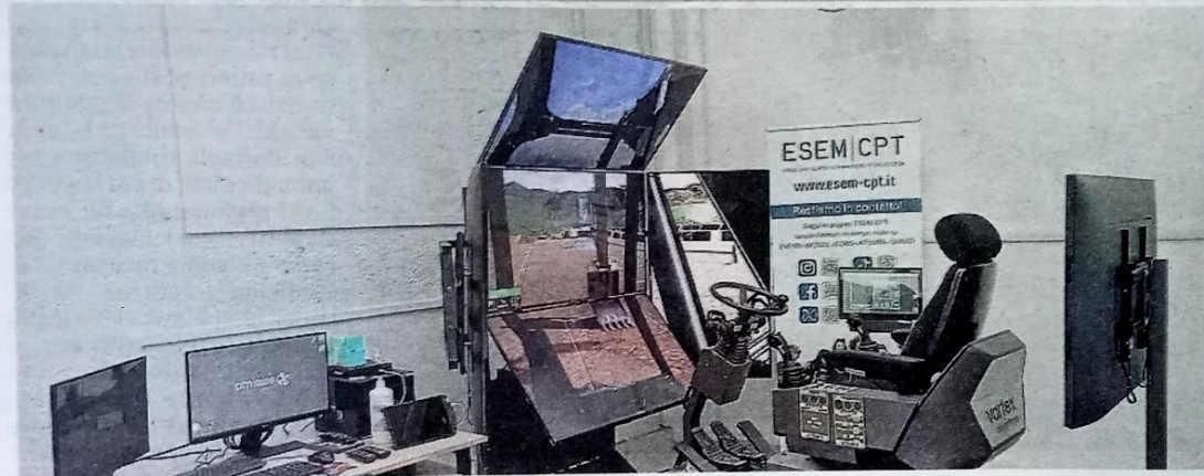
Postazione Il dispositivo di addestramento per operatori di gru e macchine movimento terra tramite la realtà aumentata
