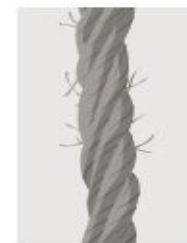
18 Fili metallici rotti
