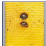
Bruciateure (schizzi saldatura)
