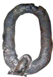
Danni da calore
