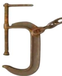
Abbinamenti e sostituzioni improprie di componenti
