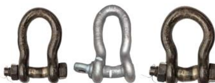
perno o corpo deformato, distorto, allungato, piegato
