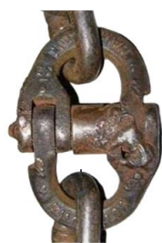
Danni da calore
